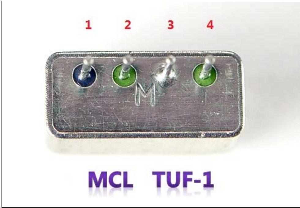
Above — RF -- Pin 1, IF -- Pin 2, Ground -- Pin 3, LO -- Pin 4.
